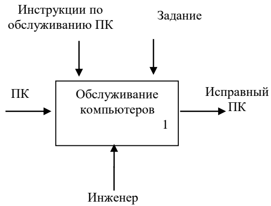
Рис. 1. Функциональный блок SADT-диаграммы
