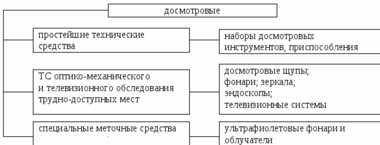
Рис. 9. Классификация досмотровых технических средств для проведения таможенного контроля
