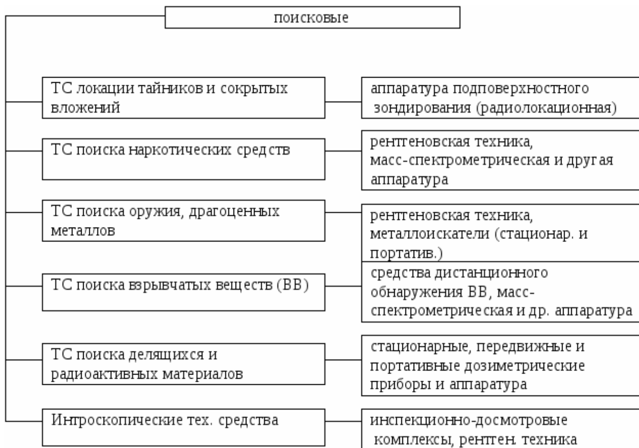
Рис. 11. Классификация поисковых технических средств для проведения таможенного контроля
