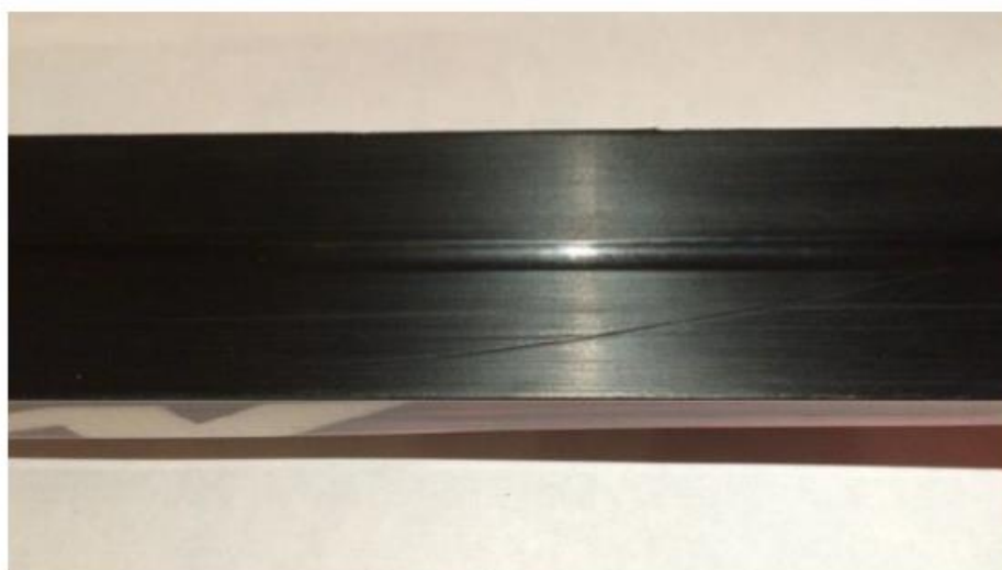
Рис. 5 Глубокая царапина на скользящей поверхности
